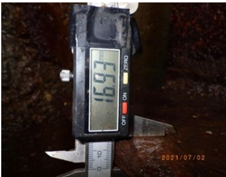
21-0591 発錆、断面減少、断面欠損-A2---1.5m2 主桁フランジ端部
